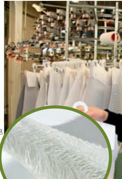
À L'IFTH (TROYES), JEAN-MARIE BACHMANN et les équipes de R&D conçoivent des "spacers" (en gros plan): des textiles aussi épais et confortables que la mousse, mais plus simples et plus écologiques.
